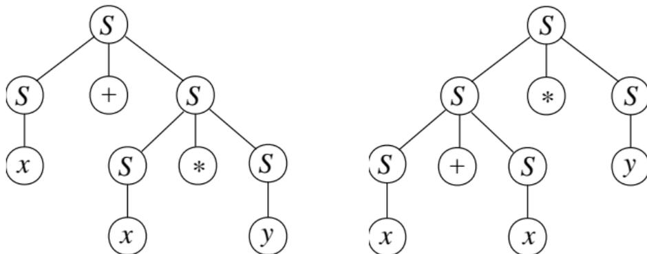
Der erste Baum führt zur Auswertung  $x + (x * y)$ , der zweite zu  $(x + x) * y$ .
